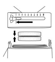
Die Einstellung ist von uns so vorjustiert, dass Sie auf der Hebelstellung 1 ein leises Schleifgeräusch der Mahlsteine hören können. Das ist die Einstellung fein, bei der sich die Mahlsteine minimal berühren.
