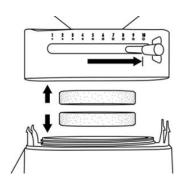
Mit Verschieben des Stellhebels verändern Sie den Abstand der Mahlsteine zueinander. Bei Hebelstellung 10 wird der Abstand größer und das Mahlgut entsprechend gröber.
